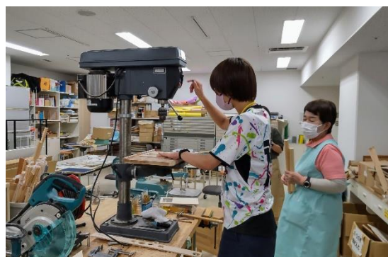
鋏を指す穴を機械であける（穴あけボール盤）
